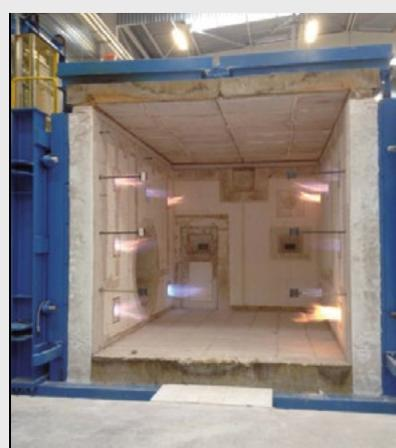
Four pour essai de résistance au feu - Efectis /
